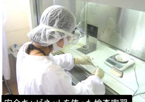
安全キャビネットを使った検査実習
